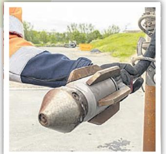
Aus dieser Düse schießt das Wasser bei der Kanalreinigung mit einem Druck von bis zu 180 bar. Deshalb ist auch hier Vorsicht angesagt und nur absolute Fachleute dürfen mit dieser Technik umgehen.
