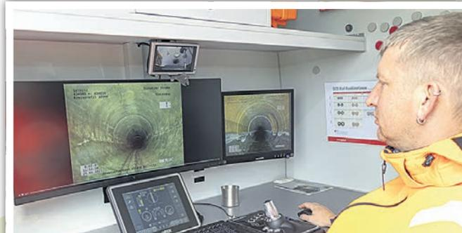
Im Inneren des Kanal-TV-Fahrzeugs können die eingegangenen Daten direkt ausgewertet und ins verbandseigene GIS eingespeist werden.
