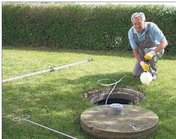
Utz Ulbrich beprobt eine Kleinkläranlage. Er ist beim Abwasserverband für die Kontrolle der Eigenkontrolle zuständig.
